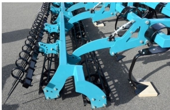
Прутковый тандемный каток со скребницами (опция)
