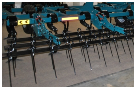
Трехрядная пружинная борона
