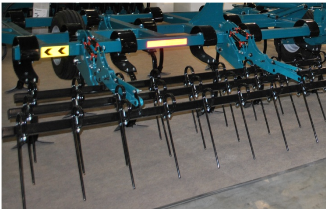
Трехрядная пружинная борона
