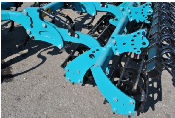
Прутковый тандемный каток со скребницами
